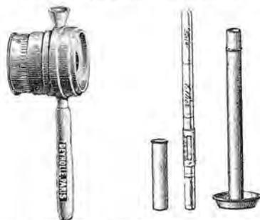
Fig. 264 bis. Fig. 264.—Lacto-butyromètre Lactoscope.
