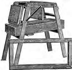
Fig. 282. — Chevalet à désoperculer avec cérificateur-mellificateur.
