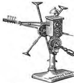
Fig. 48. — Eprouvette pour les fils.
