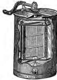
Fig. 283. — Extracteur à cadres pivotants.
