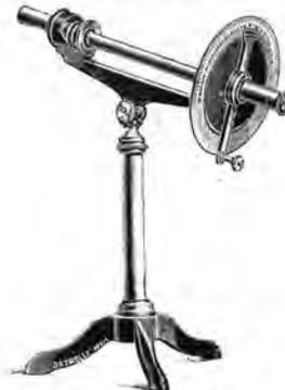
Fig. 56 bis. — Polarimètre.
