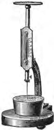
Fig. 17. — Aiguille dynamométrique et moule.
