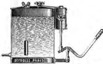
Fig. 94. — Pulvérisateur à air comprimé.
