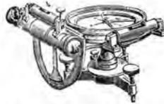
Fig. 441. — Boussole d'arpenteur.
