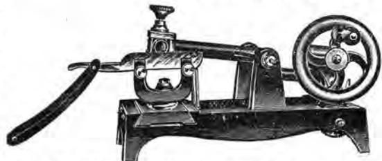
Fig. 337 bis. — Microtome automatique.
