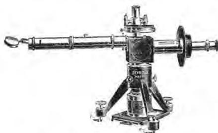
Fig. 7. — Microscope métallurgique.
