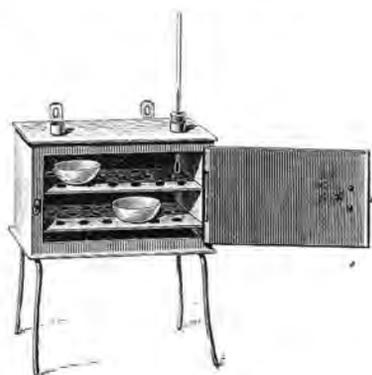
Fig. 222. — Dessiccateur à air chaud.
