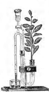
Fig. 147. Absorptiomètre.
