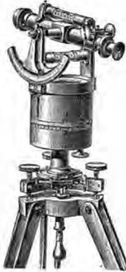
Fig. 440. — Equerre d'arpenteur.
