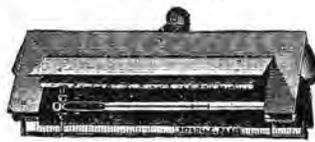
Fig. 122. — Abris pour minima-maxima.
