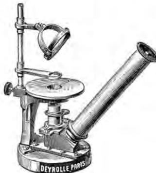
Fig. 330 bis. Microscope chimique.
