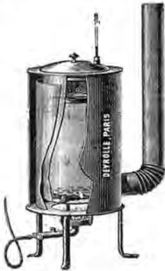
Fig. 330. Four à flamber de Pasteur.
